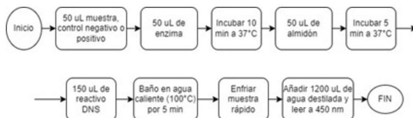
Figura 2. Proceso de adición de reactivos y muestras para la reacción DNS Fuente: propia
